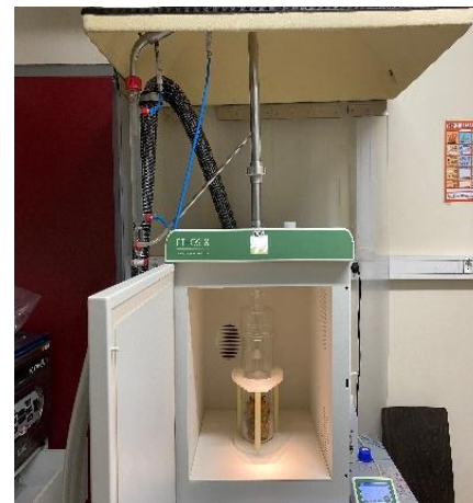
Micro-onde (SFME) : méthode innovante sans ajout d'eau
