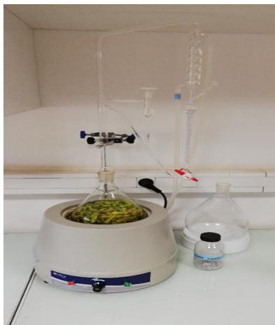
Hydrodistillation (HD) : fleurs immergées dans l'eau.
