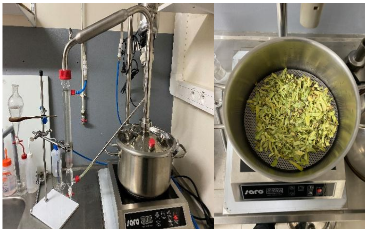
Vapohydrodistillation (SD): fleurs placées sur une grille perforée au-dessus de l'eau.
